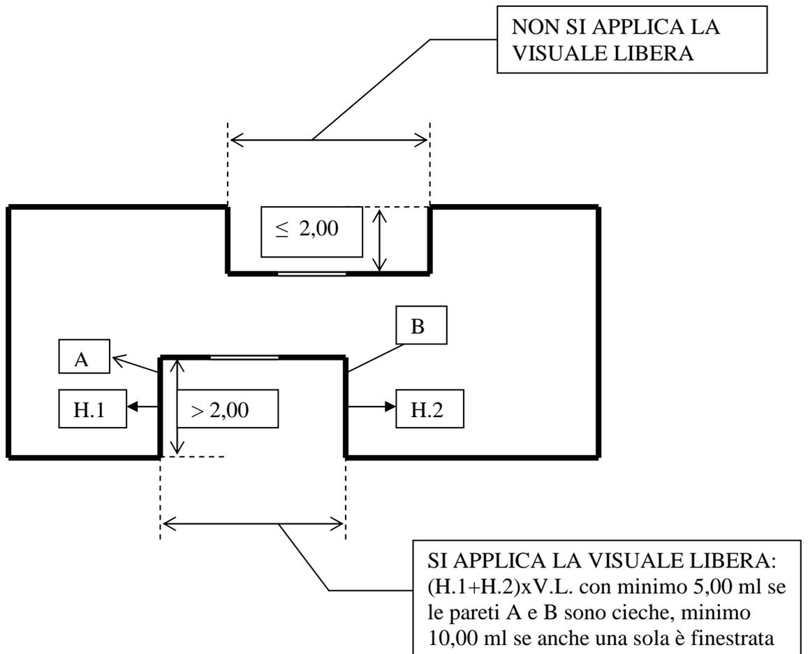
Figura 7 bis – ESEMPI DI APPLICAZIONE
