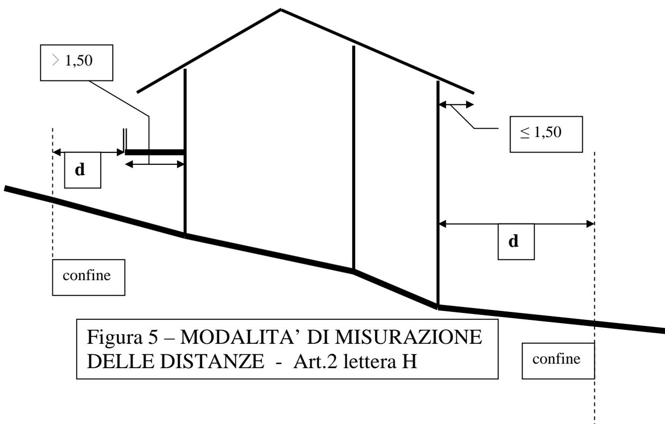
Figura 5 – MODALITA' DI MISURAZIONE DELLE DISTANZE - Art.2 lettera H
