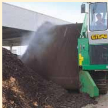
Miscelazione dei fanghi con gli scarti verdi e legnosi triturati
